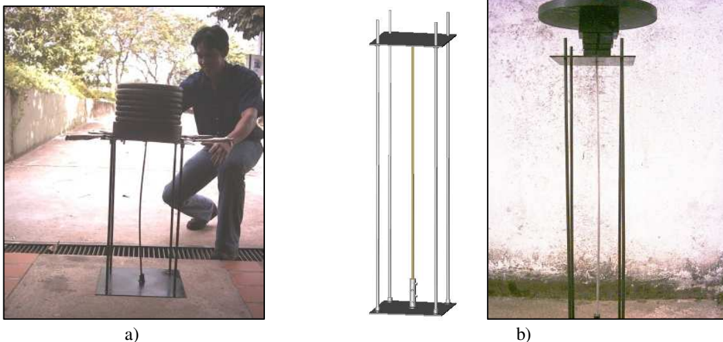
Figura 2: Estudio de columnas a) Empotrada-articulada b) Empotrada-libre.
