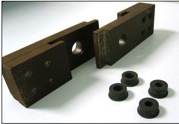
Figura 8: Diseño y construcción de un mecanismo para realizar el ensayo de flexión.
