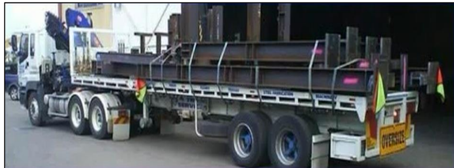
Figura 6: Carga de columnas con muñones incorporados
