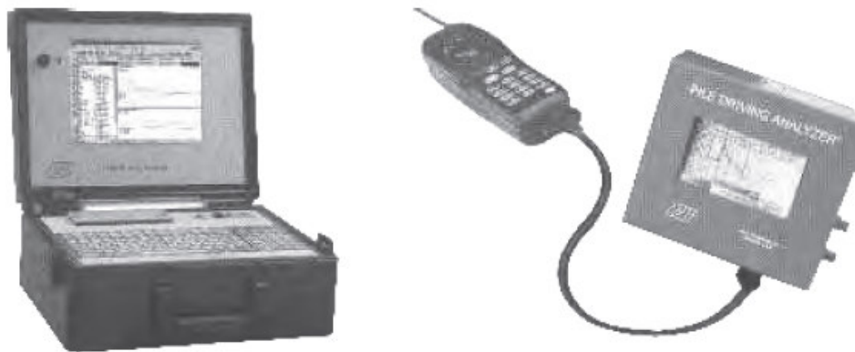
Foto 7: Equipos PDA para procesamiento de las señales de los transductores acoplados al pilote
