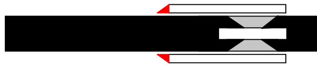
Figura 12. Posibilidad de varilla de estrangulamiento roscada con calidad de acero a elección.
